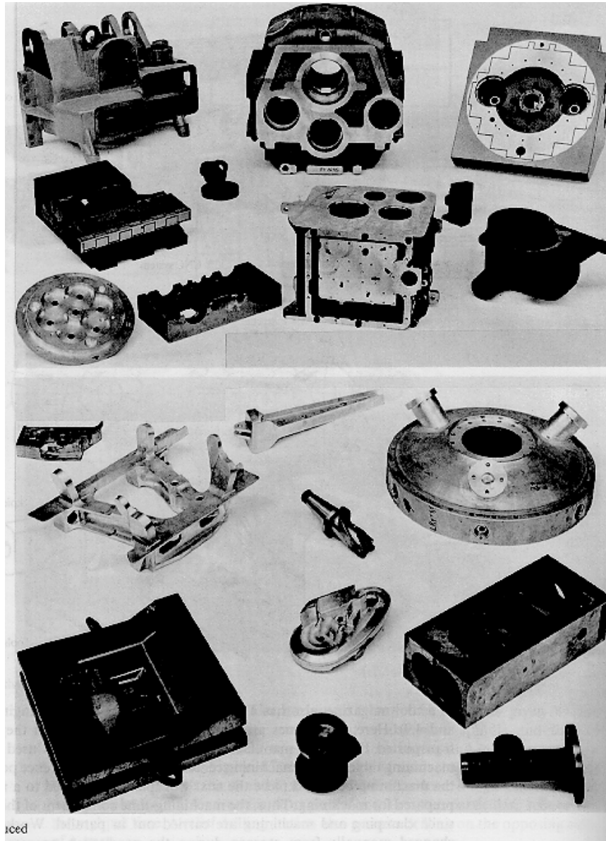
Peças complexas fabricadas numa só Máquina CNC
