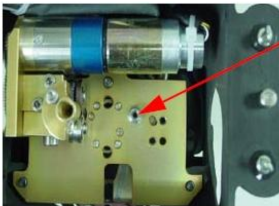
Figura 24: SST 768 & Elite – Inspeccionando o funil de entrada do fusor do suporte e o fusor do modelo.
