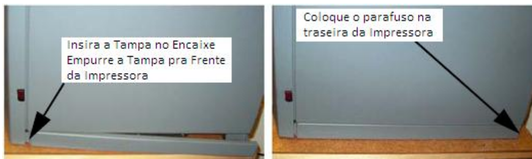
Figura 4: Instalando as Tampas de Acesso à Empilhadeira.
