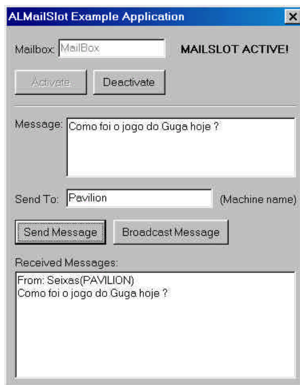
Figura 13: Este programa permite enviar e receber mensagens de qualquer usuário logado na rede.
