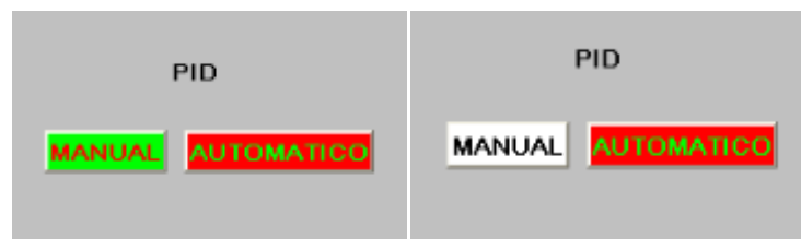
Figura 5.5 - Seleção do modo de controle do PID, mostrando quando está em controle manual.
