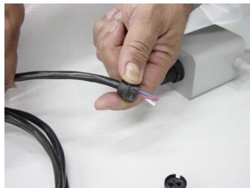
Fig. 1.18 - Montando o suporte dos fios
