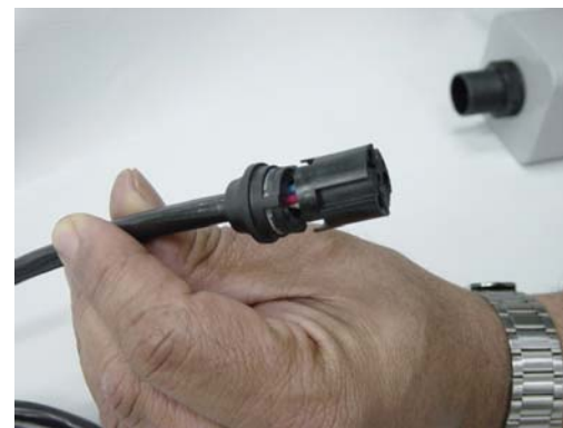
Fig. 1.14 – Conector com os fios do cabo mantidos em seus orifícios
