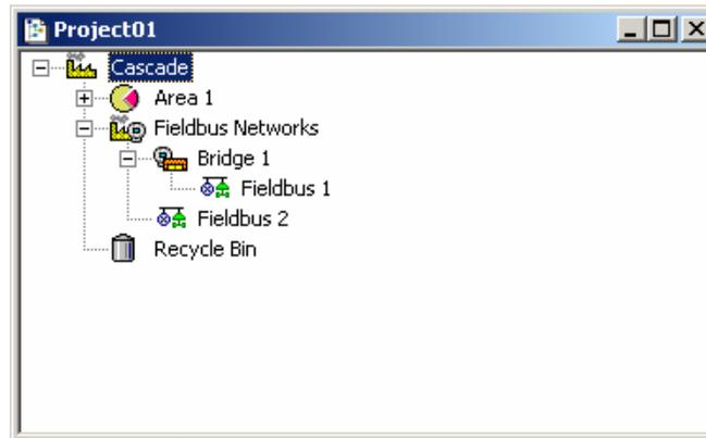
Se ao menos dois fieldbuses tiverem sido adicionados ao projeto, e uma bridge já tiver sido adicionada a um fieldbus, pode-se conectar esta bridge ao outro fieldbus.
