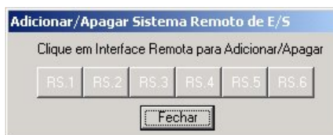
Fig 3.25-Habilitar um Módulo de E/S Remoto
