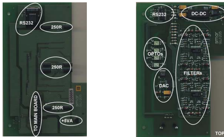
Figura 6.7 - Circuito de condicionamento do sinal e filtro passa baixa
