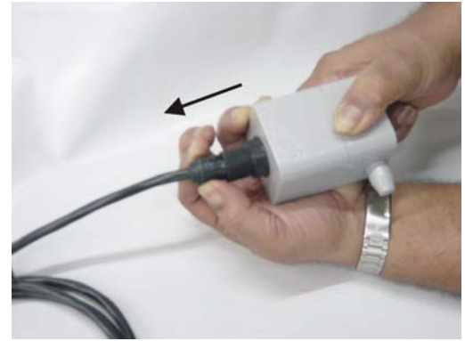
Fig. 1.13 – Desconectando o cabo do sensor Hall
