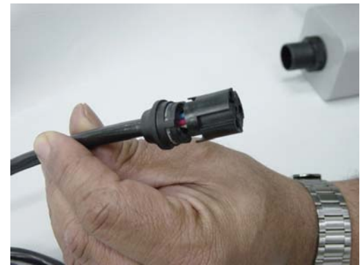
Fig. 1.15 - Conector com os fios do cabo mantidos em seus orifícios
