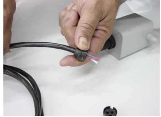
Fig. 1.19 - Montando o suporte dos fios
