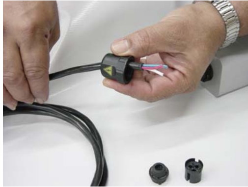
Fig. 1.18 – Montando a tampa com rosca
