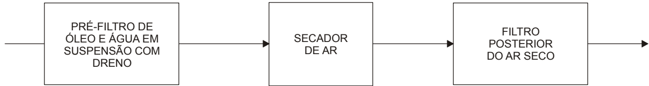
Figura 1.10 – Sistema de Condicionamento da Qualidade do Ar
