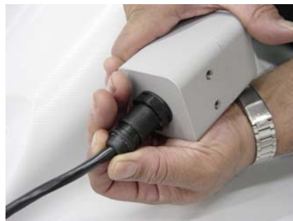
Fig. 1.22 - Acoplando o conector no Hall remoto
