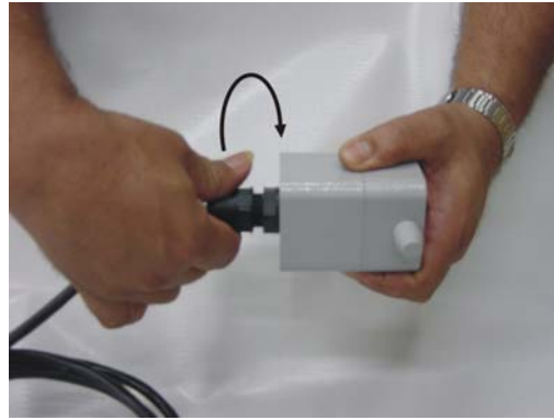
Fig. 1.12 – Desconectando a tampa rosca do cabo do sensor Hall
