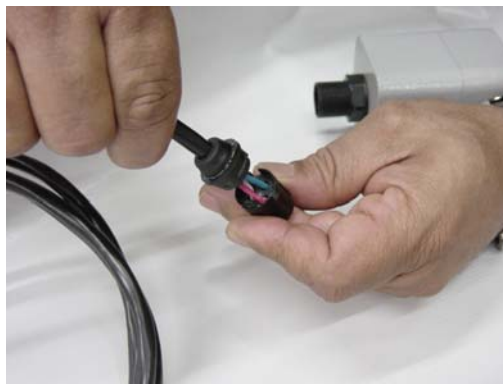
Fig. 1.20 – Montando fios no conector
