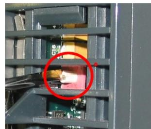
**Localizando a Rotary Switch da DF65. No detalhe: A Rotary Switch.**
