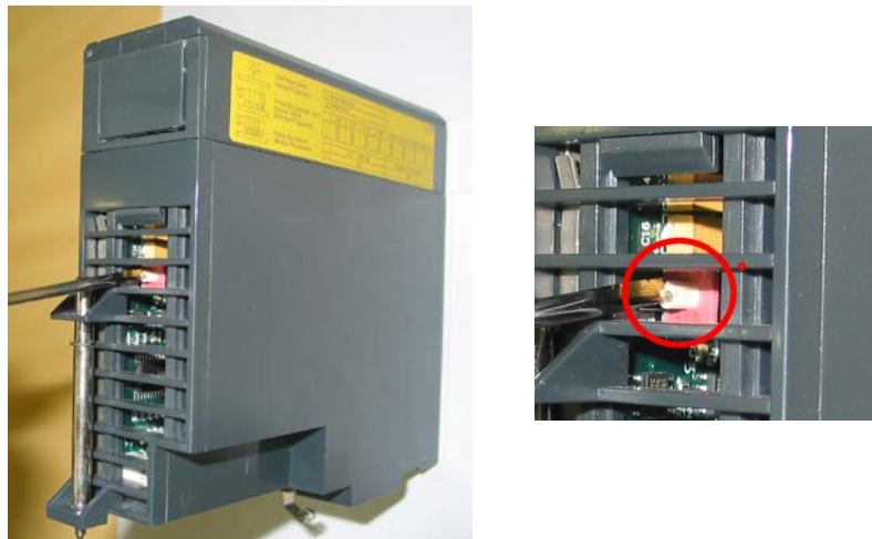
Figura 18. 10 – Localizando a Rotary Switch do DF65. No detalhe: A Rotary Switch
