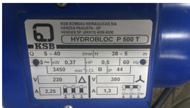
Figura 63 – Especificações da bomba hidráulica trifásica
