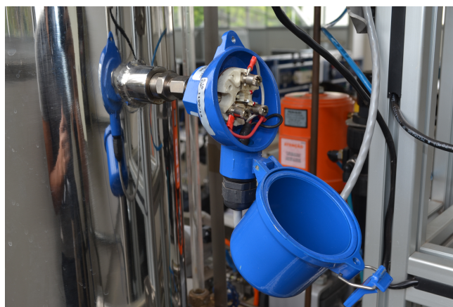
Figura 56 – Sensor PT100 com ligação a 3 fios
