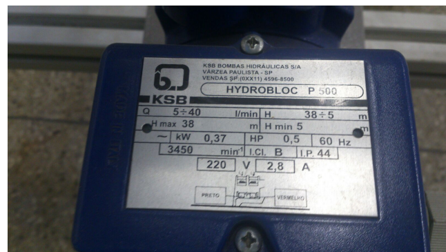
Figura 61 – Especificações bomba hidráulica monofásica
