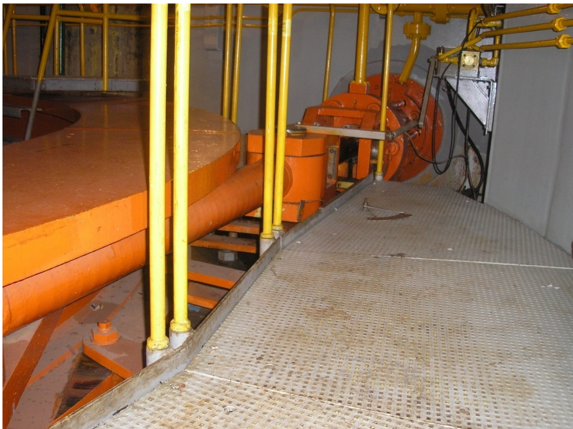
FIGURA 5: MECANISMO QUE TRANSFORMA MOVIMENTO DESLIZANTE EM ROTATIVO E MECANISMO PARA SENSOR DE POSIÇÃO.
