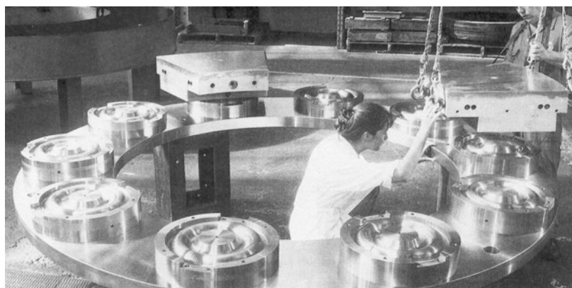
Figura 4.4 – Montagem dos patins sobre o conjunto de membranas do mancal escora.
