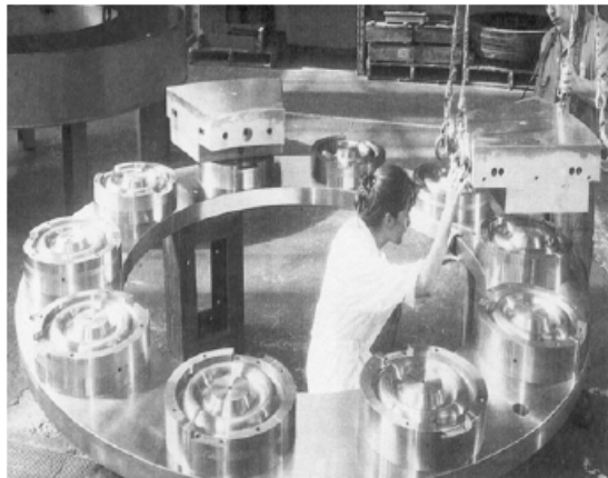
Fig. 1: Montagem dos patins sobre o conjunto de membranas do mancal escora.
