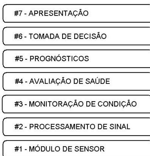
Fig. 1: Arquitetura OSA-CBM e suas 7 camadas
