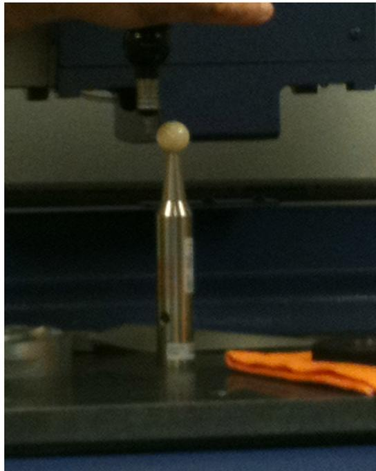
**Figura 4.17: esfera para calibração inicial da MMC QM-Measure 353.**
