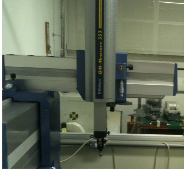
**Figura 2.2: braço da máquina de medir por coordenadas QM-Measure 353.**
