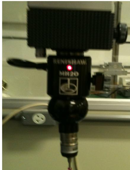
**Figura 2.3: Apalpador articulado utilizado na MMC.**
