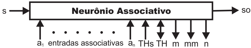
Figura 3.1: Neurônio Associativo de Haikonen. Adaptado de Haikonen (2000a, Fig. 3.1). O neurônio associativo tem uma entrada principal s , um certo número de entradas associativas a_i , um sinal de controle de limiar de aprendizado sináptico THs , um sinal de controle limiar bidirecional da saída do neurônio TH e sinais de saída: so , m , mm , n . m , mm e n , representam, respectivamente, sinais de: casamento de padrão (em inglês, match ), falta de combinação (em inglês, mismatch ) e detecção de novidades. O número de entradas associativas a_i não é limitado ou fixo, uma vez que seus pesos sinápticos não são ajustados entre si. Todos os valores de entrada ou saída podem assumir somente valores entre zero e um.
