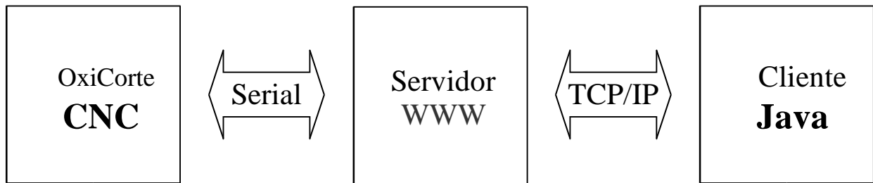
Figura 1. Arquitetura de Teloperação do Sistema WebOxiCorte.
