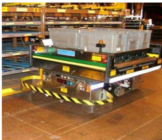
Figura 4. AGV para transporte de materiais fabricado pela empresa norte americana Oregon.
