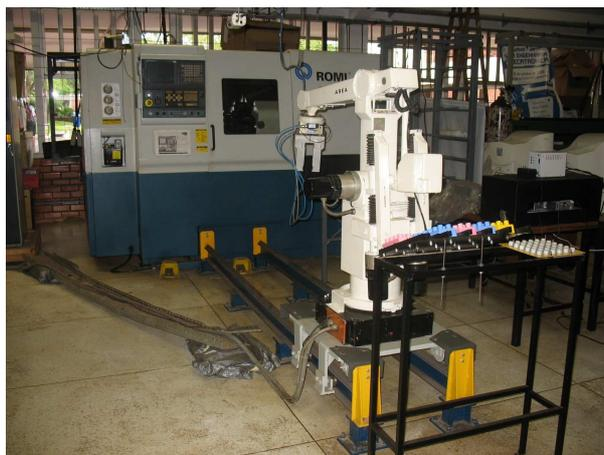
Figura 3. Célula de manufatura composta por torno CNC (comando numérico computadorizado) e um robô manipulador montado sobre trilhos - GRACO/UnB.
