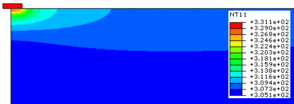
Figura 8 Resultado da simulação utilizando o método implícito (Temperatura em K).
