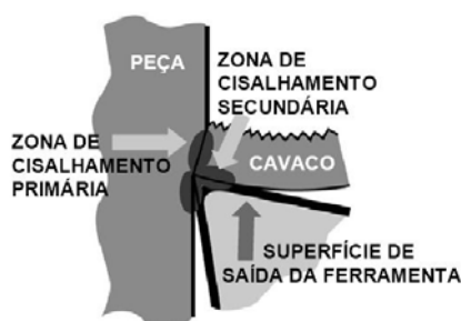
Figura 1 Modelo clássico de formação de cavacos com a zona primária e secundária de cisalhamento em corte ortogonal
