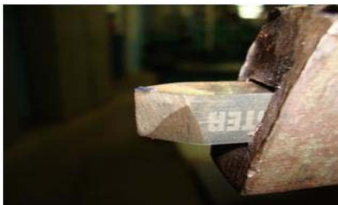
**Figura 5. Ferramenta de corte de HSS com ponta destruída**
