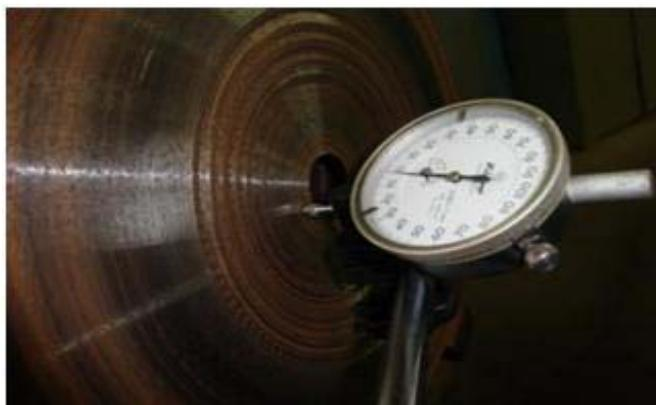
**Figura 3. Verificação do recuo de ponta da ferramenta ( $D_{0,2}$ )**
