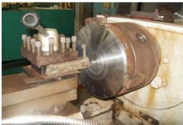
**Figura 2. Ensaio de faceamento rápido de Brandsma**
