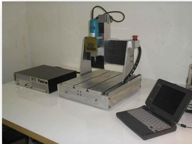
Figura 3.3 : *Router* CNC, MTC Robótica. Fonte: Site da Empresa
