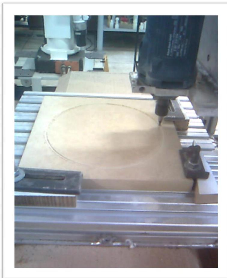
Figura 3.20: Detalhe da mesa de trabalho com uma peça sendo usinada.
