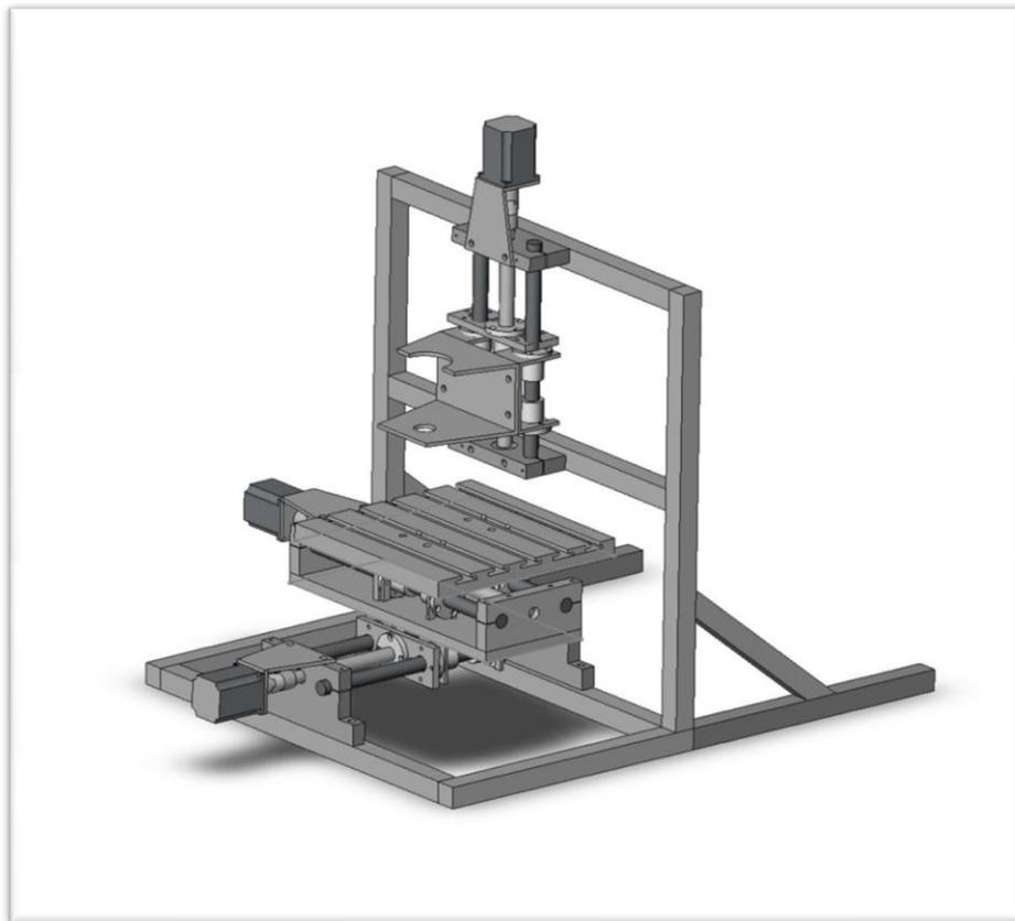
Figura 3.15: Modelo inicial da fresadora CNC.
