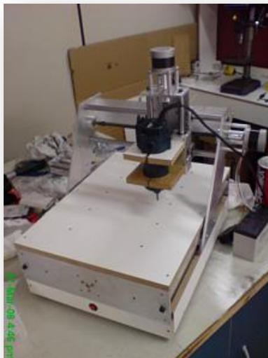
Figura 3.4 : *Router* CNC, IO Robotics. Fonte: Site da Empresa
