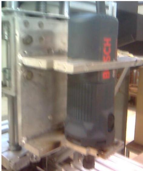
Figura 3.27: Resultado do sistema de fixação da retificadora.
