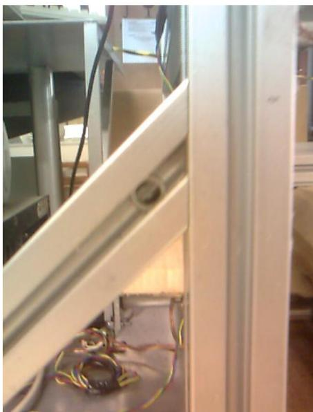
Figura 3.23: Detalhe do elemento de união dos perfis em alumínio.
