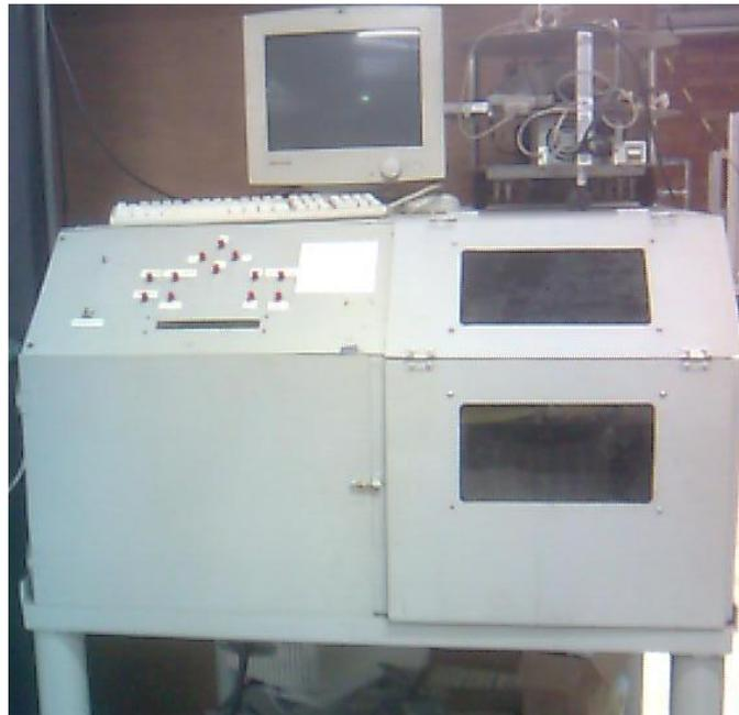
Figura 2.8: Foto do torno CNC didático da UnB.
