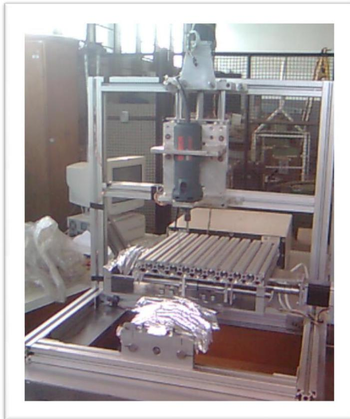
Figura 3.38: Foto da Fresadora CNC Didática.
