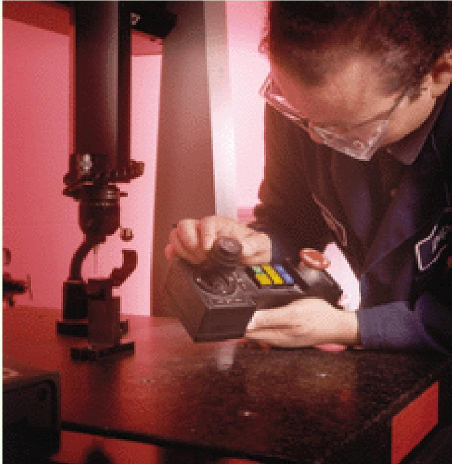
*Um operador em uma célula verifica a qualidade final de uma peça em uma máquina de medição por coordenadas (CMM).*
