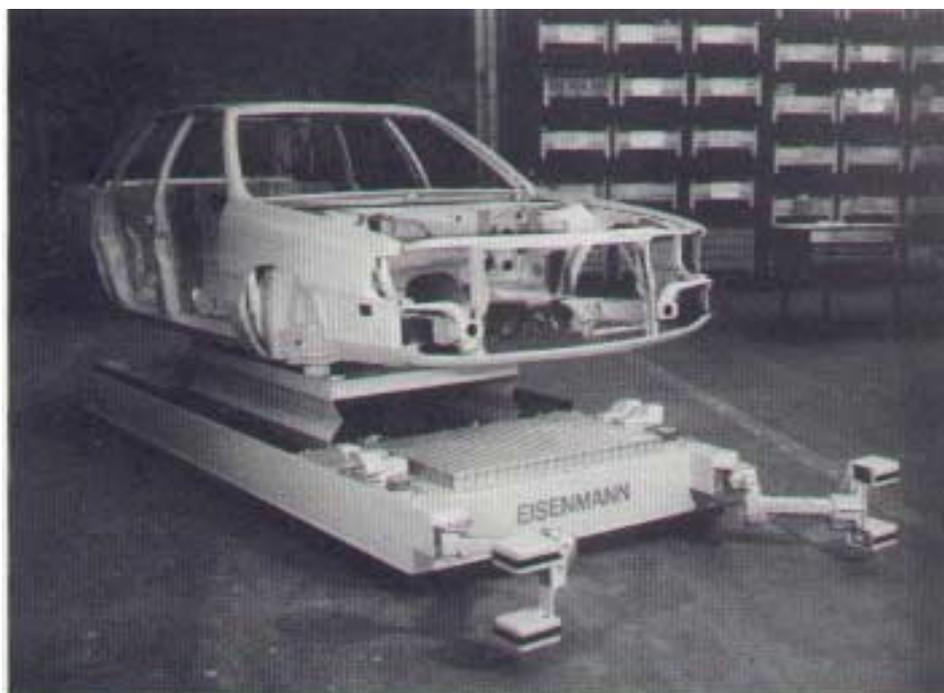
**Figura 8.21.** Um AGV carregando um chassi
