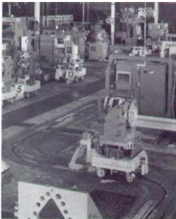
**Figura 8.18.** Um transportador puxado por corrente usado num sistema de manufatura
