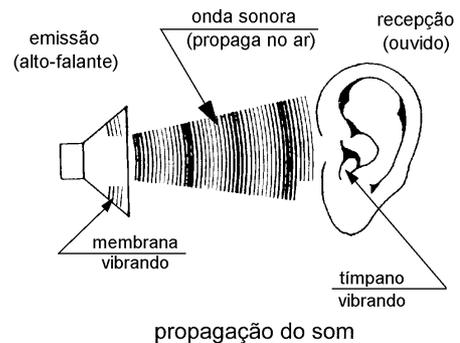
Nesta aula e na próxima estudaremos a realização do ensaio por ultra-som. Nesse ensaio, induzimos, por meio de um emissor, ondas ultra-sônicas que se propagam através do material que desejamos analisar. Pelo eco captado no receptor, determina-se a existência ou não de discontinuidades.
