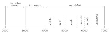
comprimento de onda Å (Angstrom) 1 Angstrom =  $10^{-10}$ m A luz negra tem a propriedade de causar o fenômeno da **fluorescência** em certas substâncias. Sua radiação não é visível. É produzida por um arco elétrico que passa pelo vapor de mercúrio.
