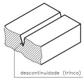
O ensaio consiste em aplicar um líquido penetrante sobre a superfície a ser ensaiada. Após remover o excesso da superfície, faz-se sair da descontinuidade o líquido penetrante retido, utilizando-se para isso um revelador.
