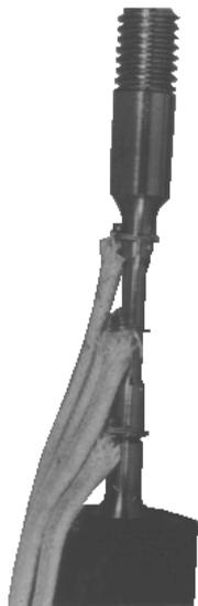
**Termopar:** são dois fios de materiais diferentes, unidos nas pontas por solda, que geram uma diferença de potencial quando as pontas são submetidas a temperaturas diferentes.
