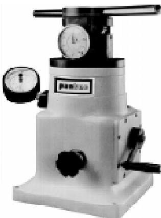
Os ensaios de embutimento são realizados por meio de dispositivos acoplados a um equipamento que transmite força. Podem ser feitos na já conhecida máquina universal de ensaios, adaptada com os dispositivos próprios, ou numa máquina específica para este ensaio, como a que mostramos ao lado.
