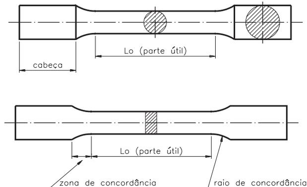
A **parte útil** do corpo de prova, identificada no desenho anterior por  $L_0$ , é a região onde são feitas as medidas das propriedades mecânicas do material.
