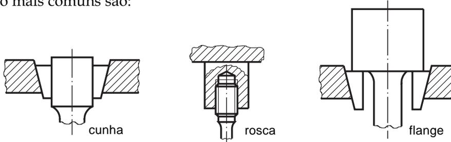
Entre as cabeças e a parte útil há um raio de concordância para evitar que a ruptura ocorra fora da parte útil do corpo de prova (Lo).
