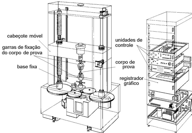
Fixa-se o corpo de prova na máquina por suas extremidades, numa posição que permite ao equipamento aplicar-lhe uma força axial para fora, de modo a aumentar seu comprimento.
