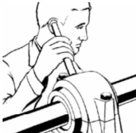
Para ouvir o funcionamento do rolamento usa-se um bastão de madeira, uma chave de fenda ou objetos similares o mais próximo possível do rolamento. Coloca-se o ouvido junto à outra extremidade do objeto. Se o ruído for suave é porque o rolamento está em bom estado. Se o ruído for uniforme mas apresentar um som metálico, é necessário lubrificar o rolamento. Atualmente, existe o **analisador de vibração** que permite identificar a folga e a intensidade da vibração do rolamento.
