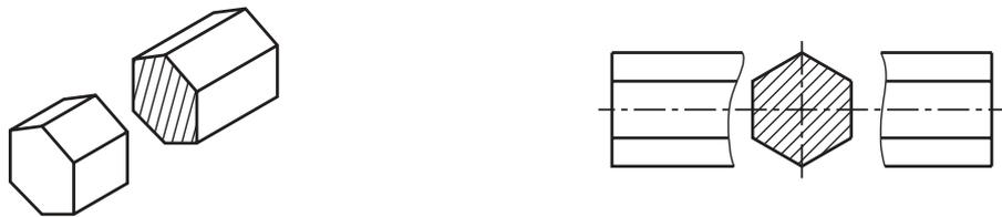
Quando a seção é representada interrompendo as vistas do desenho técnico, ela não vem identificada pela palavra seção, seguida pelas letras do alfabeto.
