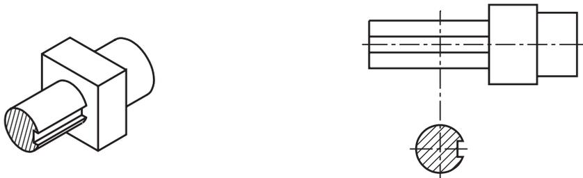
Neste caso, a seção aparece ligada à vista por uma linha traço e ponto estreita, que indica o local por onde se imaginou passar o plano de corte.
