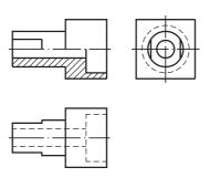
A escolha da vista onde o meio-corte deve ser representado depende das formas do modelo e das posições dos elementos que se quer analisar.
