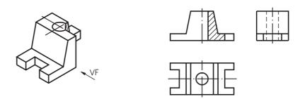
Sempre que a linha de simetria que atravessa a vista em corte for **vertical**, a parte representada em corte deve ficar **à direita**, conforme recomendação da ABNT.
