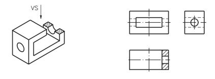
No desenho, a linha de simetria que atravessa a vista superior é vertical. Assim, a parte em corte deve ser representada no desenho à direita.
