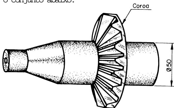
Nesse conjunto, o diâmetro do furo da coroa deverá ser 0,05 mm menor do que o diâmetro do eixo. Seu problema é descobrir a quantos graus a coroa deve ser aquecida para se obter o encaixe com o aperto desejado.
