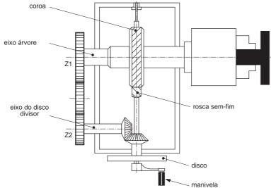
Porém, nem sempre são usadas apenas duas engrenagens para a correção. Conforme o caso, a fração é desmembrada em duas e você terá de calcular 4 engrenagens.
