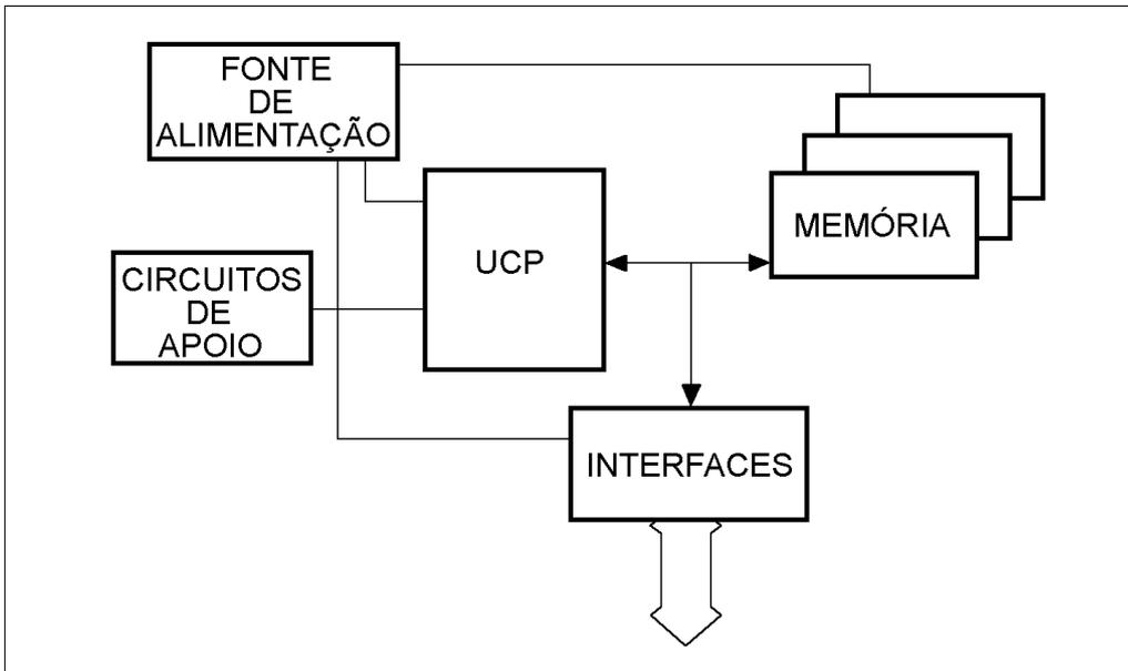
O diagrama apresentado mostra os componentes básicos de um microcomputador, que normalmente se encontram no gabinete do micro.
