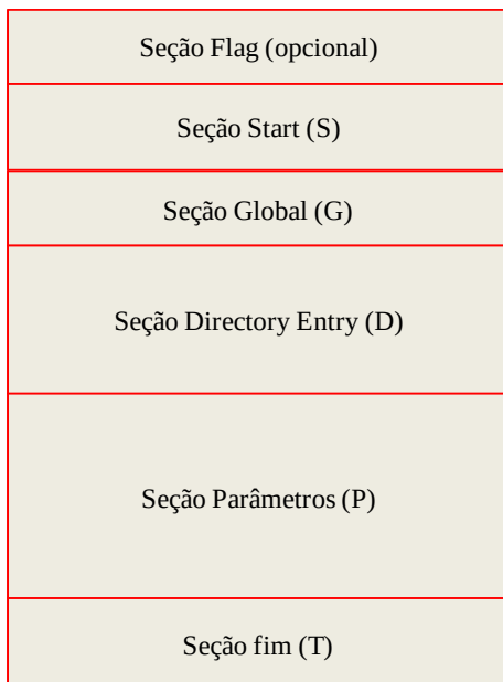
Figura 2.4. Estrutura geral de um arquivo IGES.
