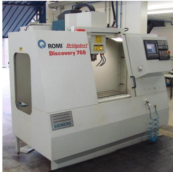
Figura 4.2: Centro de Usinagem Discovery 760 Romi®
