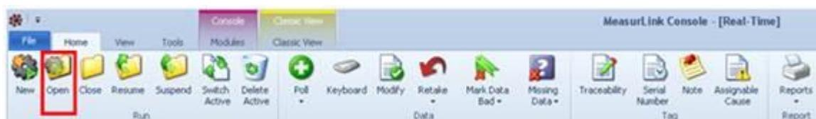
1. Para abrir uma corrida, clique em Abrir na guia Início. Em seguida, expanda a árvore conforme necessário para ver a corrida e, em seguida, clique duas vezes no nome da corrida para abrir. As corridas fechadas são abertas (corridas suspensas são reiniciadas, mas é simplesmente uma pasta diferente para armazenamento).
