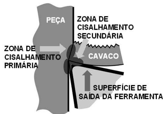
Figura 2.9 - Zona de cisalhamento primária e secundária na peça durante a usinagem.
