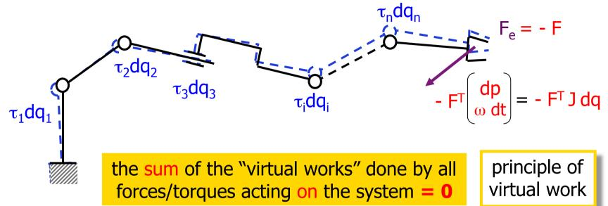
$$\tau^T dq - F^T \begin{bmatrix} dp \\ \omega dt \end{bmatrix} = \tau^T dq - F^T J dq = \mathbf{0} \quad \forall dq$$
