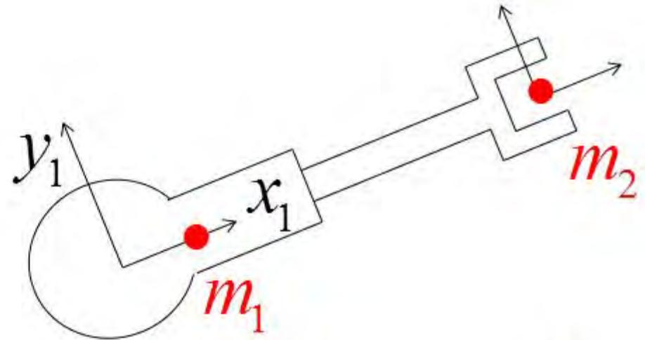
$${}^0 M_x = \begin{pmatrix} c1 & -s1 \\ s1 & c1 \end{pmatrix} \begin{pmatrix} m_2 & 0 \\ 0 & m_2 + m'_2 \end{pmatrix} \begin{pmatrix} c1 & s1 \\ -s1 & c1 \end{pmatrix}$$
