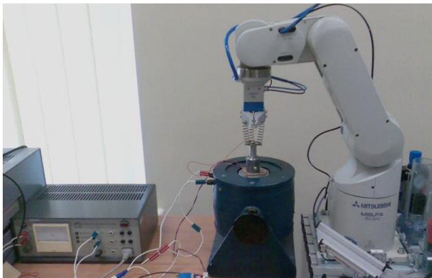
5 pav. Bendras veleno įstatymo į įvorę stendo vaizdas
