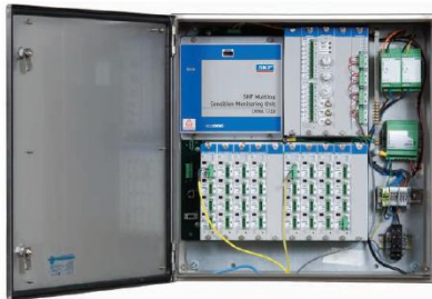
10 pav. Daugiakanalis virpesių analizatorius - valdiklis CMMA 7710.
