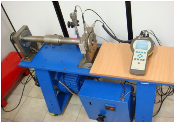
4 pav. Specialiai modernizuoto TSDI laboratorinio stendo bendras vaizdas ir danų firmos Bruel & Kjar virpesių matuoklis Vibrotest 60
