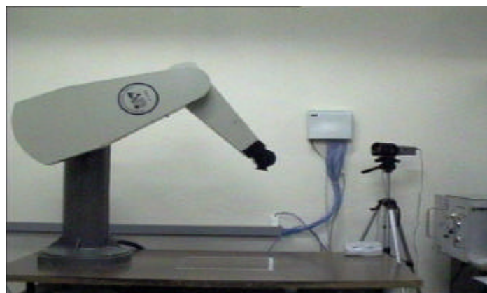
Figura 2 – PUMA 560, manipulador utilizado na indústria
