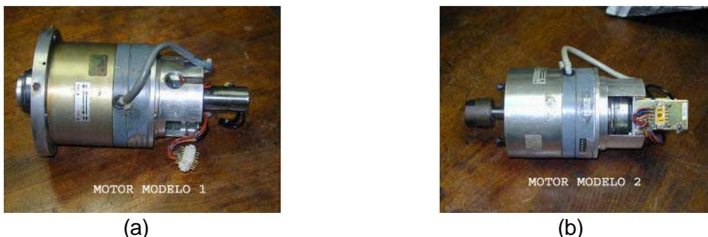
Figura 4. Motores do robô IRB6: (a) motor modelo 1: sem freio (b) motor modelo 2: com freio.
