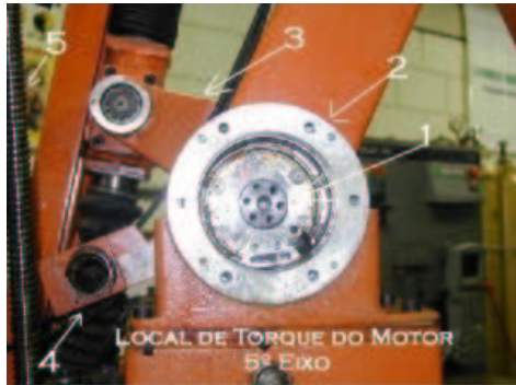
Figura 5: Fuso (5) e alavanca (3) de atuação da junta 2, alavanca de atuação da junta 3 (4) e acoplamento para o atuador da junta 5.
