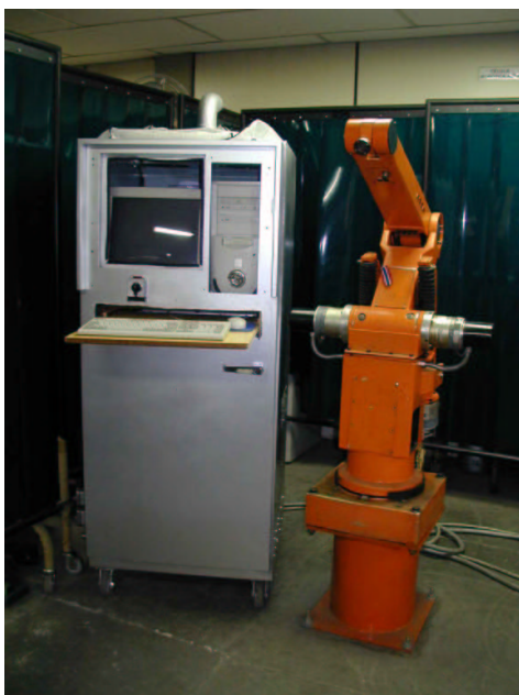
Figura 13: Vista frontal do gabinete do controlador.
