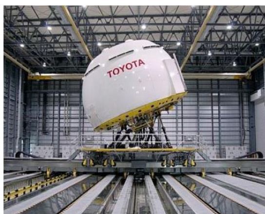
FIGURA 2.13 - Simulador de dirigibilidade de veículo.
