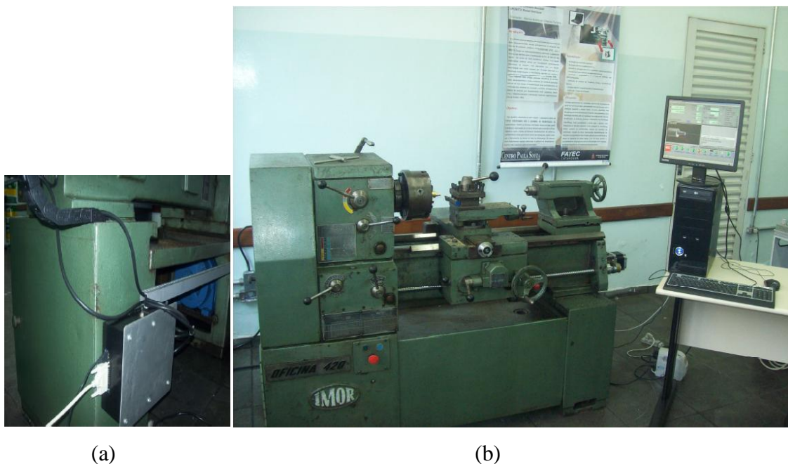
FIGURA 2.34 - (a) Gabinete de controle utilizado no retrofitting e (b) torno mecânico convencional controlado por CNC.
