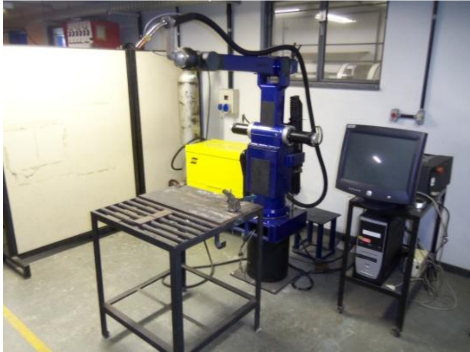
FIGURA 4.18 – Célula Robótica do LRSS constituída pelo manipulador ASEA, após o processo de overhauling .
