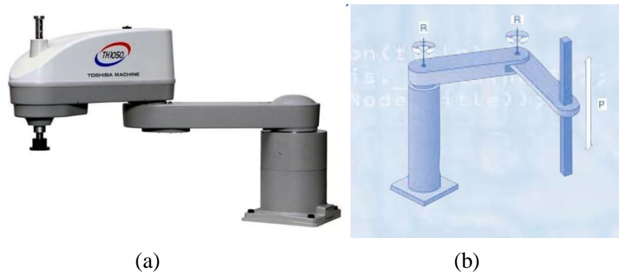
FIGURA 2.12 - (a) Robô SCARA modelo TH1050 produzido pela Toshiba e (b) movimentos de cada junta de um Robô SCARA.
