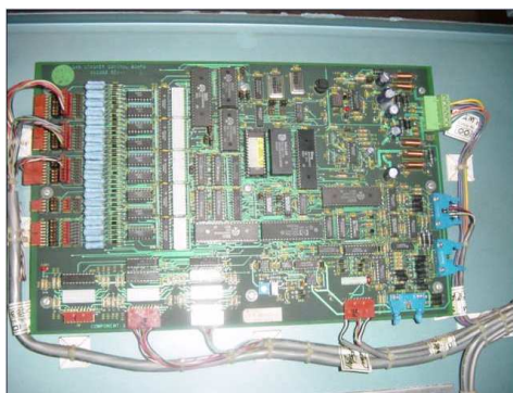
Figura 2 – Antiga placa controladora do Stacker
