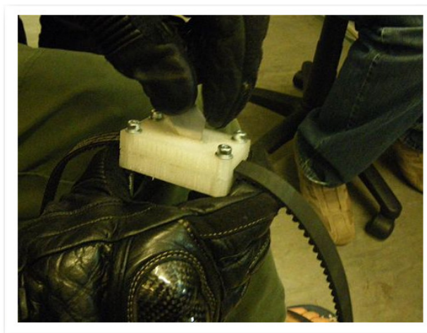
Figura 6.3: Mecanismo de corte das correias.
