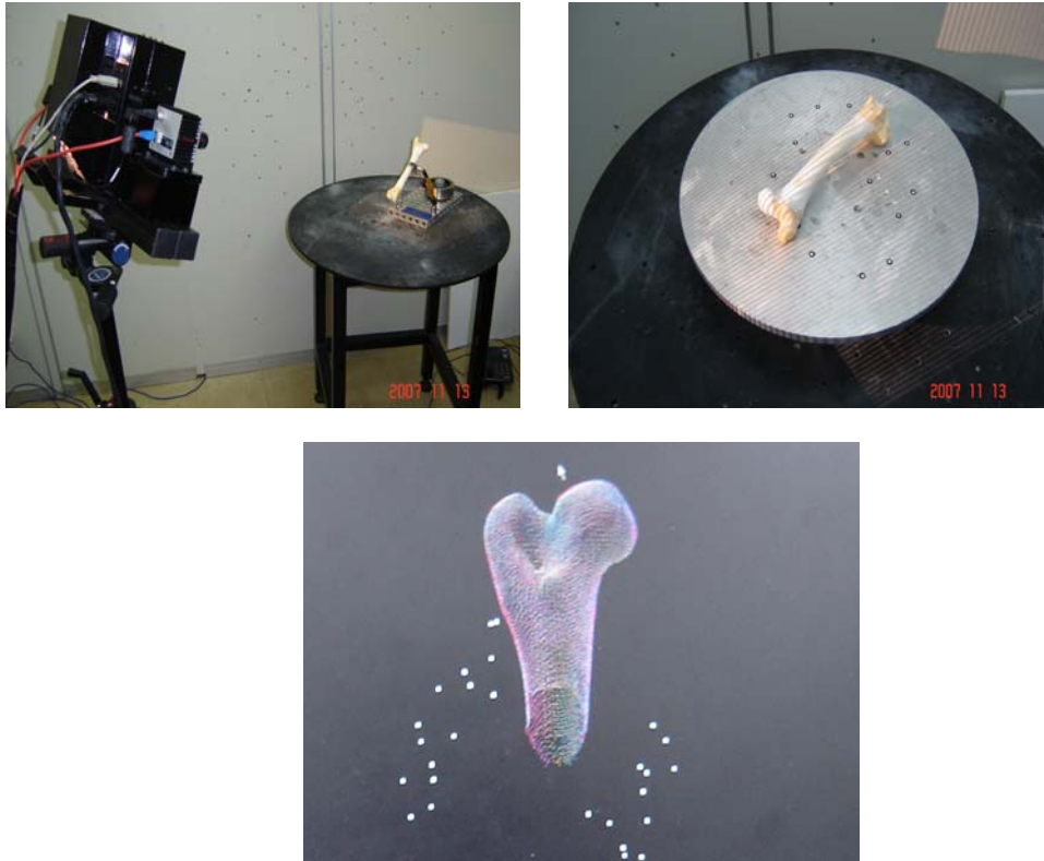
Figura 31 - Fotos das medições e nuvem de pontos.
